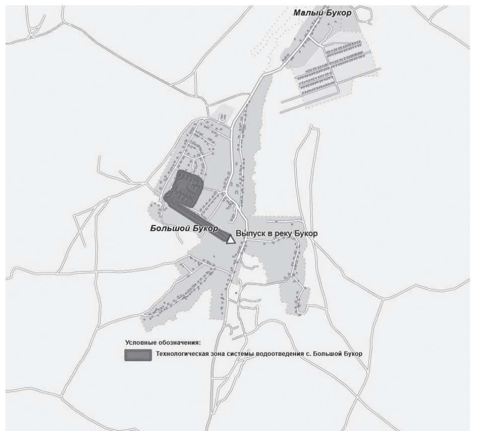
Рисунок 3.20. Технологическая зона системы водоотведения с. Большой Букор
